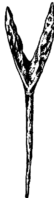
Рис. 6.9. Y-образный наконечник с наваренными рогами
