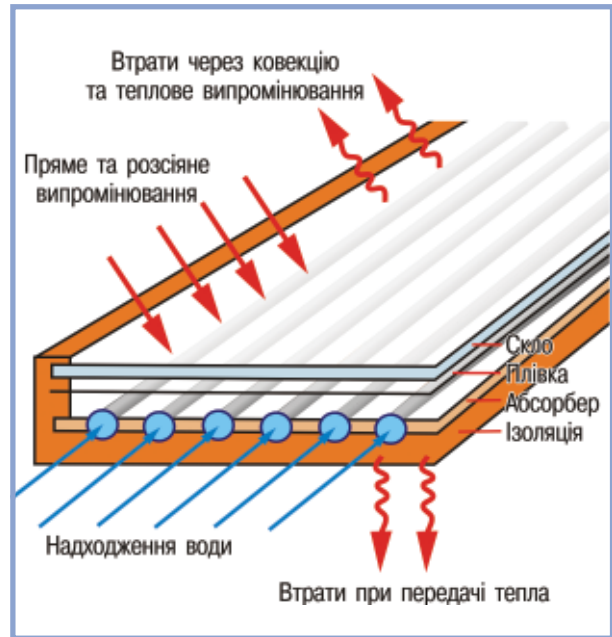
Рис.1 Схема плоского колектора
