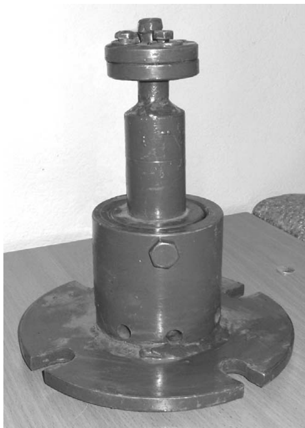
Рис. 2. Устройство дистанционного аварийного раскрытия противопожарного трубопровода «УДАР-2»
