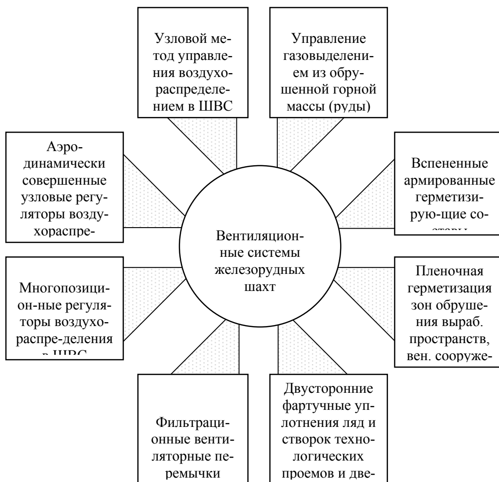
Рис. 1. Блок-схема новых способов и средств повышения эффективности, экономичности и надёжности вентиляционных режимов действующих железорудных шахт
