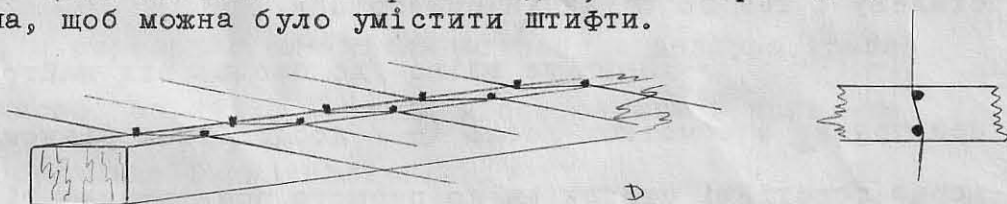
Рис. 2: форма прямокутна, для змоги горю умістити два штифти поміж які струна у легкому заломанні пробігає.
