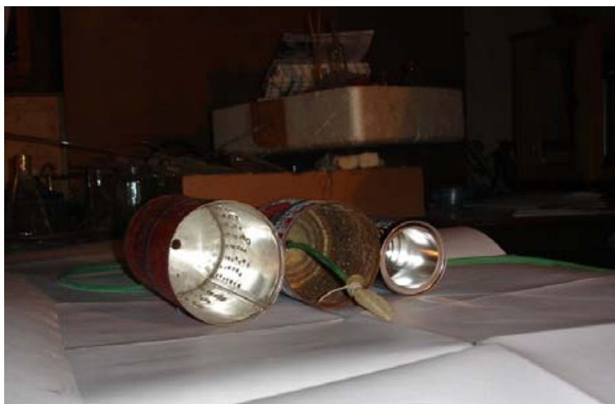
Рис.4. Общий вид установки для лабораторных исследований: 1 — емкость заданного объема; 2 — элемент, создающий распор в породе; 3 — гибкий шланг
