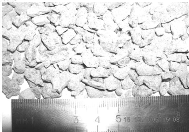
Рис. 1. Гранулометрический состав породной фракции
