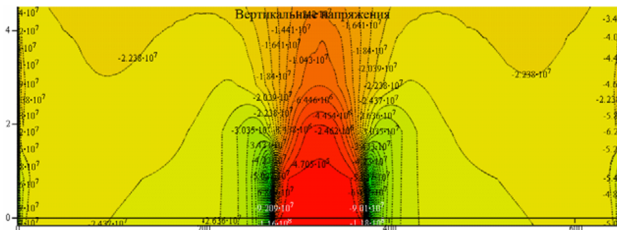
Рис. 3. Распределение вертикальных напряжений над выработанным пространством лавы (размер зоны в/п 200 м)
