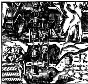
Рис.8 Элеватор приводится в действие водяным колесом
