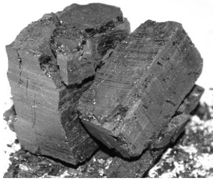
Рис. 3. Разрушенный образец угля.
