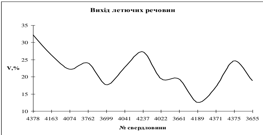
Рис. 3 Графік зміни виходу летючих речовин по свердловинах, які розташовані за падінням шахтного поля
