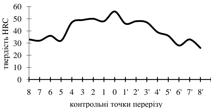
Рисунок 2. – Графік розподілу твердості по перетину різця РК32/70-01
