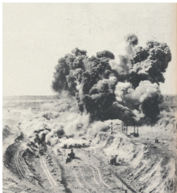
Вибух на викид у кар'єрі Новокриворізького гірничозбагачувального комбінату.
