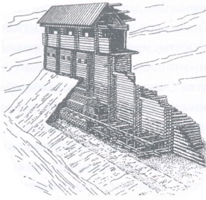
Конструкція оборонного валу з городнями у Білгороді. Кінець X ст. Реконструкція Б. Рибаківа
