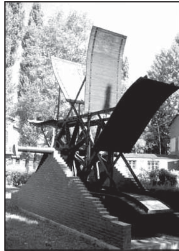
Ручний вентиляційний пристрій
