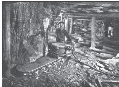
Створення врубу в підшві вугільного пласта з використанням ланцюгової врубової машини (Катовіце, початок XX ст.)
