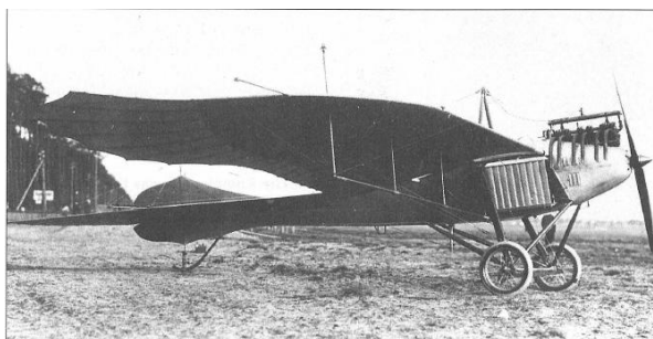
Rumpler 3C , модель 1913 года. Стоял на вооружении фронтовых частей до конца 1914; затем долгое время использовался в качестве учебного самолета. Двигатель - Mercedes D.I, 105 л.с. (Фотография из личного архива П.М. Гроша).
