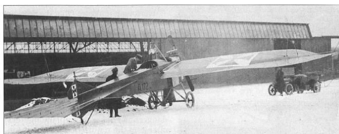
Jeannin Stahltaube , сфотографированный зимой 1914 года. Один из наиболее совершенных типов Taube . Этот Taube относится к машинам образца 1914 года. Ранние версии Jeannin Stahltaube имели несколько иную конструкцию хвостового оперения. Самолет оснащен 100-сильным двигателем Opel Argus As.I. Иногда могли устанавливаться двигатели Austro-Daimler, 120 л.с, а также двигатели Mercedes D.I. (Фотография из личного архива П.М. Гроша).
