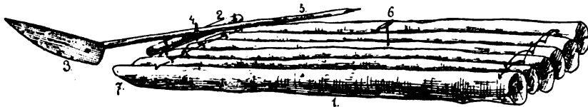
126. Тальба. 1. Ковбки підчулені від чола 7; вони повязані в поперек розкрутам; 2. столець, в яким ходять на сворени 4. керма зложена в дошки 3. і друга 5; 6. свердел або сохар.
