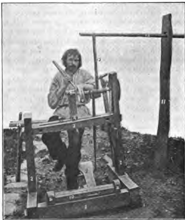
223 Василь Шкрибляк при токарні. 1. Підстава; 2. 2. стовпи; 3. огниво; 4. заяць; 5. валок; 6. матеріял на ракву; 7. решітце; 8. кривуля; 9. постіль; 10. воротило, яке ходить у жабках а. а.; 11. стовп; 12. жердка; 13. ремінь; 14. сідець.
