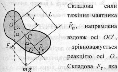
Рис. 27 Складова сили тяжіння маятника \vec{F}_n , напрямлена вздовж осі OO' , зрівноважується реакцією осі O . Складова F_t , яка перпендикулярна до OC , намагається повернути маятник у положення рівноваги.
