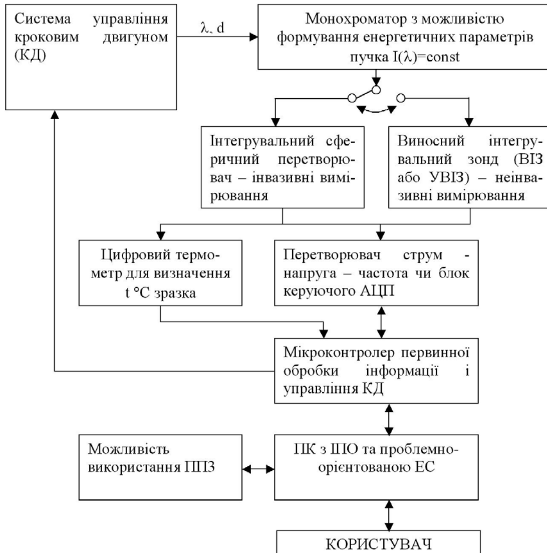
Рис. 4.6. Схема роботи типової інтерактивної комп'ютерної спектрофотометричної вимірювальної системи для медичної діагностики
