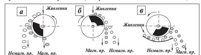
Рис. Режими розділення частинок при магнітній сепарації: а – відхилення; б – утримання; в – вилучення.
