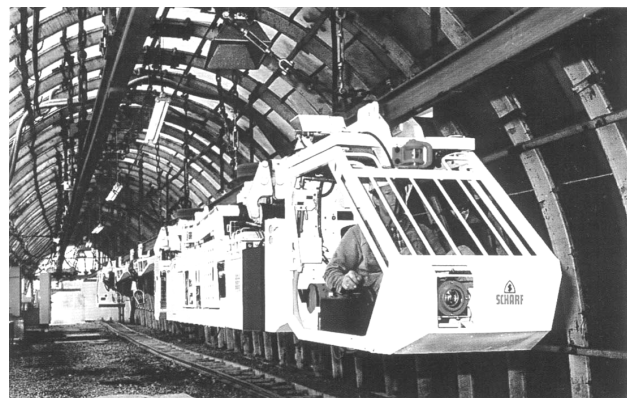
Монорейкова дорога фірми „DBT” (Deutsche Bergbau Technik).
