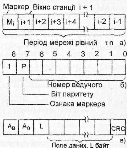
Рис. 5.17. Інтервально-маркерний доступ до моноканалу: а) діаграма одного періоду мережі; б) маркер; в) формат повідомлення
