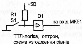
Рис.4.3. Схема узгодження двійкового давача з МК51
