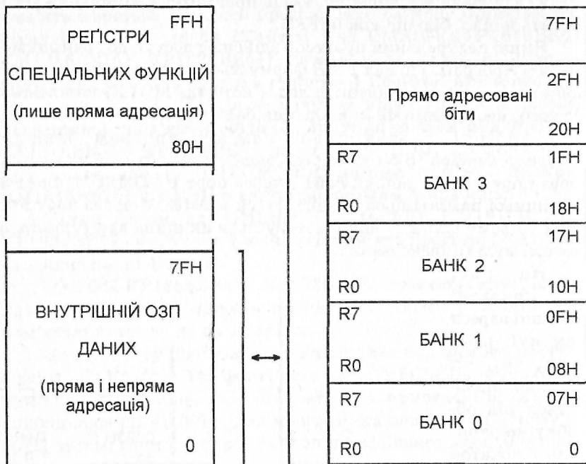
Рис. 3.25. Адресний простір внутрішньої пам'яті даних
