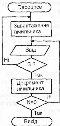
Рис. 4.7. Метод 1: підрахунок заданого числа співпадінь значень сигналів
