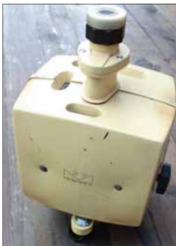
Оптико-механічний магнітометр М27, який застосовували під час археолого-магнітометричних досліджень поселень Майданецьке, Коновка, Главан та ін. в 70-ті рр.
