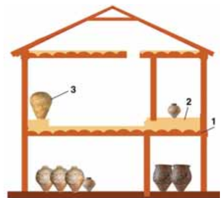
Схема реконструкції споруди трипільської культури за даними розкопок, згідно підходу, запропонованого В. І. Маркевичем. 1 – дерево; 2 – глина; 3 – кераміка.
