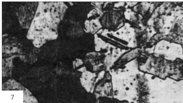
Рис. 17. Мікроструктури (1, 2, 5–8 — збільшено у 120 разів; 3, 4 — збільшено у 70 разів). 1, 2 — шило-проколка, Заліщики; 3, 4 — шило-проколка, Кліщів (3 — на черешку; 4 — на робочому вістрі); 5, 6 — шило-проколка, Тальянки (5 — на черешку; 6 — на робочому вістрі); зливки, Веселий Кут.
